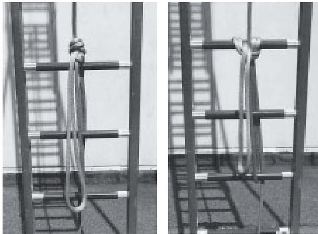
Die Leiter wird angelegt und die Stützstangen werden seitlich so ausgerichtet, daß ein Durchbiegen und seitliches Verschieben der Leiter vermieden wird. Der befohlene Trupp steigt auf und ein. Der andere Trupp sichert die Leiter an den Stützstangen.
